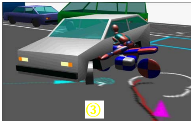
<그림 14> 컴퓨터시뮬레이션 PC-CRASH 결과 : 충돌직후 승용차의 거동과 자세변화(①~⑥). ==> 본문 41면에 첨부한 동영상 CD의 「No.3」 내용중 일부 발췌.
