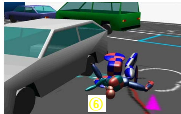
<그림 14> 컴퓨터시뮬레이션 PC-CRASH 결과 : 충돌직후 승용차의 거동과 자세변화(①~⑥). ==> 본문 41면에 첨부한 동영상 CD의 「No.3」 내용중 일부 발췌.
